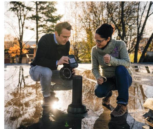
Sensoren überwachen Flachdächer und messen den Feuchtigkeitsgehalt.
